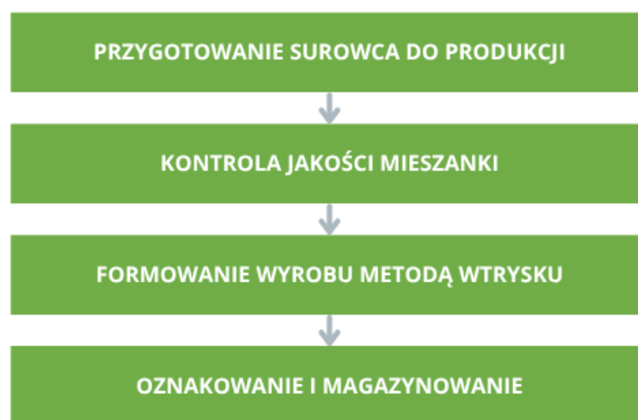
Rysunek 5.2: Uproszczony schemat produkcyjny eko kratek geoSYSTEM
